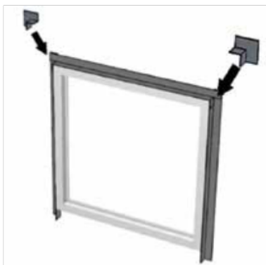
Figure 13 : Pose sur 3 côtés (avec ou sans angles préformés)
