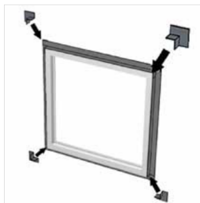
Figure 14 : Pose sur 4 côtés (avec ou sans angles préformés)
