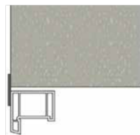
Figure 8 : Exemple de pose de menuiserie en pose tunnel au nu extérieur
