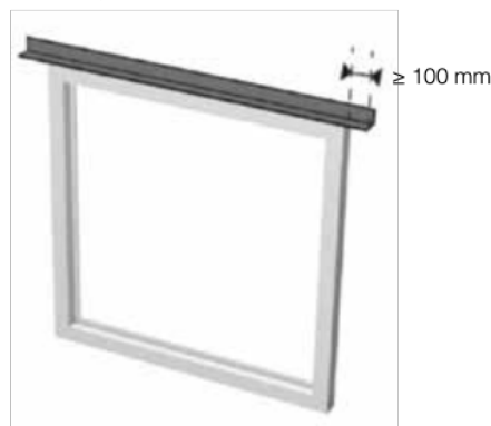
Figure 11 : Pose avec débordement
